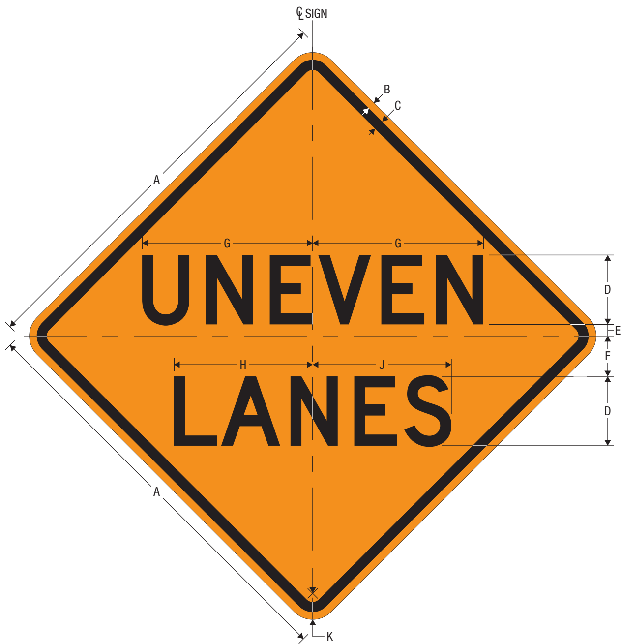
CW8-11 UNEVEN LANES
