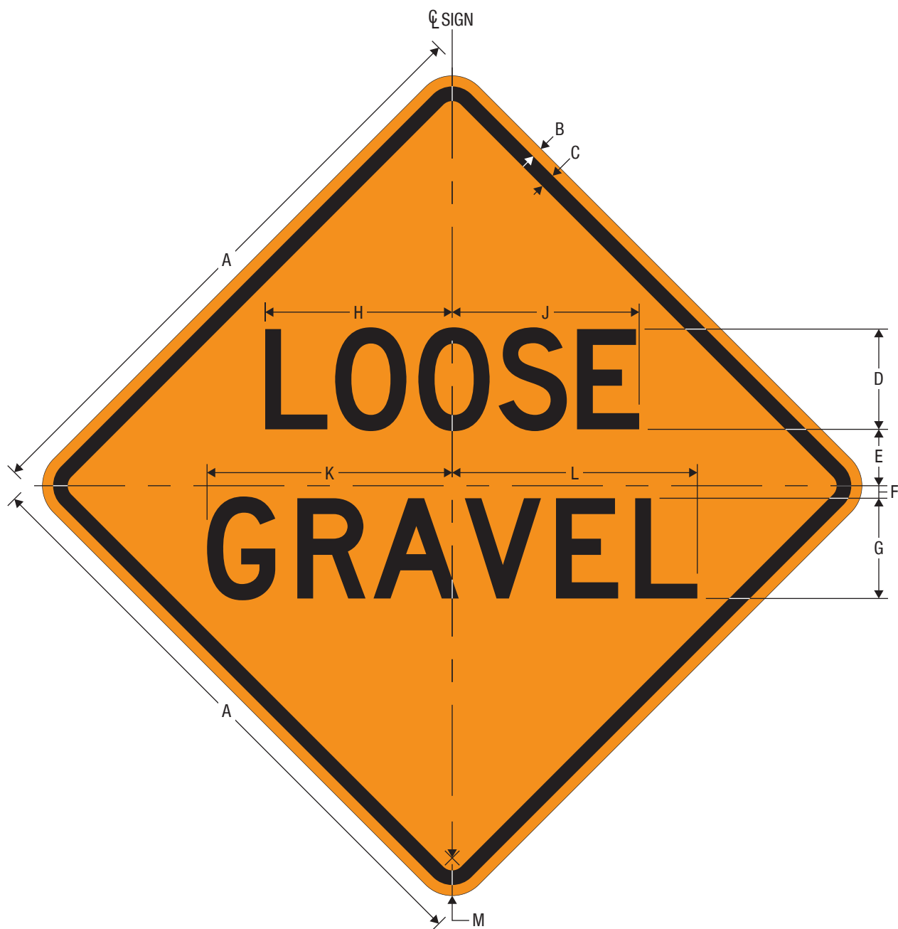
CW8-7 LOOSE GRAVEL
