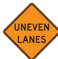
CW8-11 UNEVEN LANES
