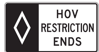
R3-15c HOV Lane Ends (Overhead)
